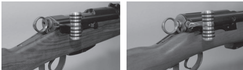
Bild 25: Riegelgriff anatomisch zu Karabiner und Langgewehr
