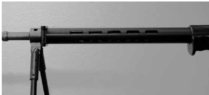
Bild 16: Mantelrohr zu Stgw 57
